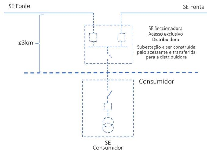
Figura 5 – Conexão Subestação Seccionadora próxima ao Consumidor
