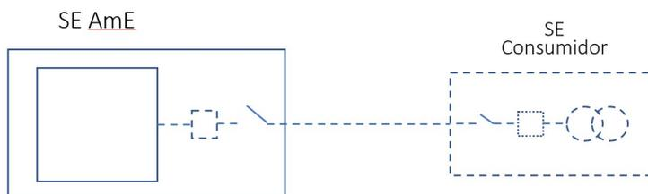
Figura 1 – Conexão Direta em Subestação existente
