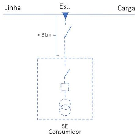
Figura 3 – Conexão através de Chave Seccionadora Tripolar
