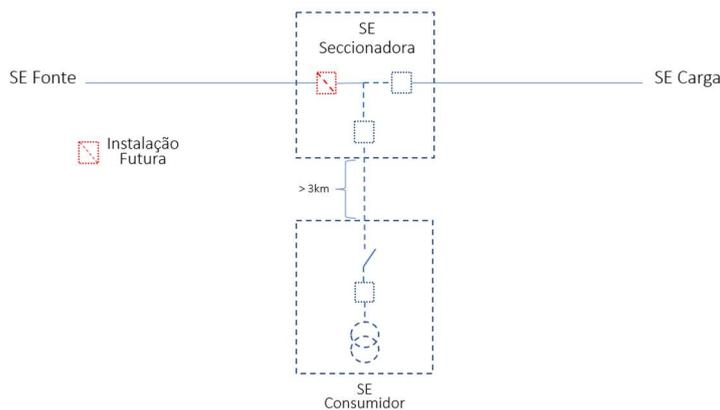
Figura 6.2 – Conexão Subestação Seccionadora – Circuito Radial
