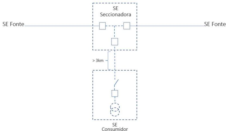
Figura 6.1 – Conexão Subestação Seccionadora – Circuito em Anel
