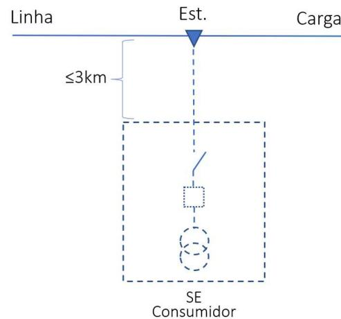
Figura 2 – Conexão através de Conector de Abertura
