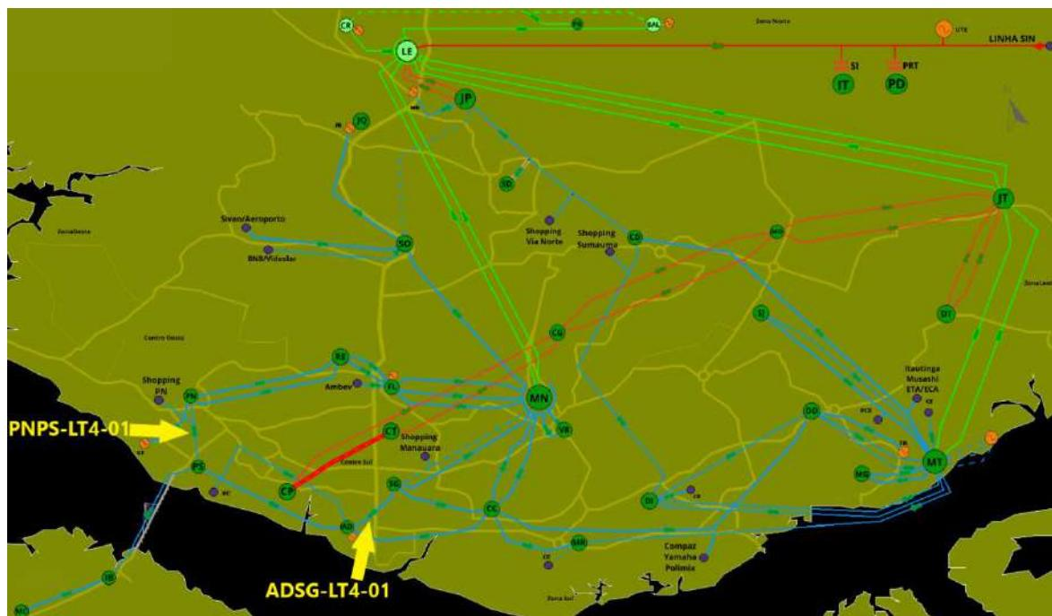
Figura 11. Destaque dos trechos afetados por descarga atmosférica no dia 06/11
